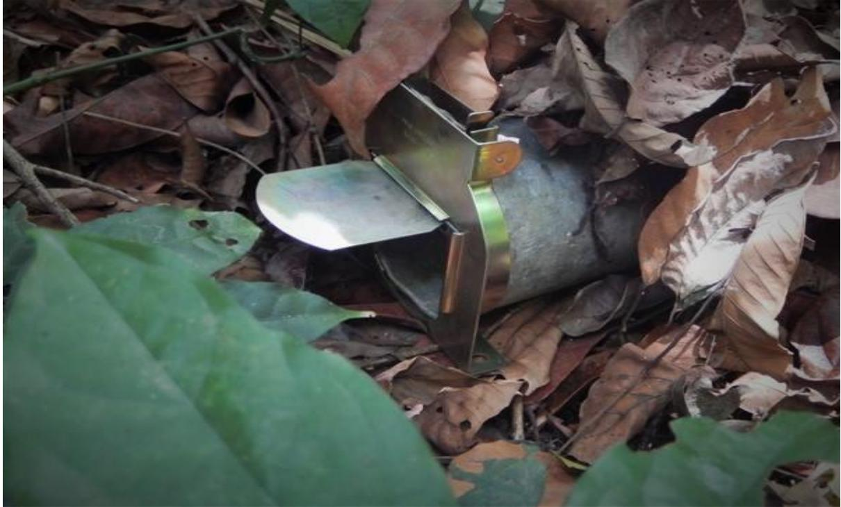
Annexe 2b : ligne de trous-pièges Pitfalls: Dispositif comprenant une barriere obligeant le rongeur à se diriger vers le puits
