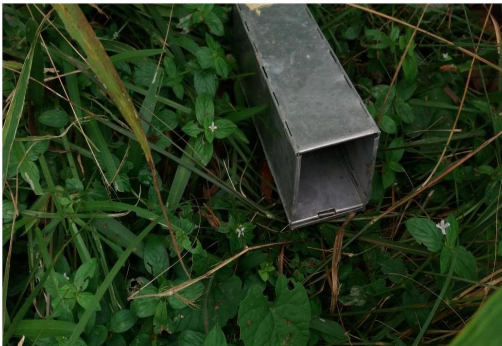
Figure 24a : Photographie de piège de type Sherman en position armée
